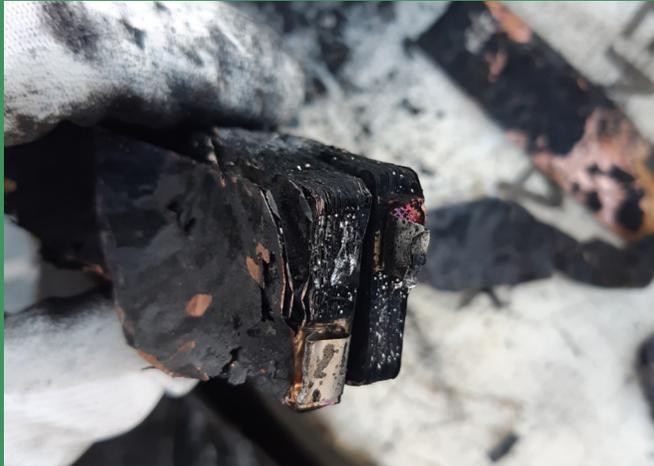
Sollte sich eine einzelne Zelle durch Wärme, Überladung oder mechanische Beschädigung zersetzen oder überhitzen, entstehen in der Zelle Temperaturen bis zu 800°C. Die Zelle öffnet sich und bläst ihren Inhalt unter Überdruck nach außen ab. Dabei entsteht meist ein Feuer oder der dabei austretende Rauch entzündet sich und verursacht eine Stichflamme.
